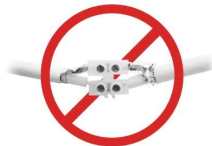
Kabler med forkerte eller dårlige samlinger
